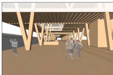
Fachwerktragsystem im Perronbereich (Machbarkeitsstudie, s.a. Anhang 3, Plan J16-430-MS1-008)
